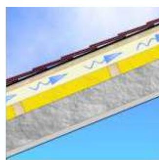
Iarna, circulația aerului va face în așa fel încât materialul izolant să rămână uscat evitând în acest fel formarea de condens și garantând o durată mai mare de viață a elementelor componente ale acoperișului.
